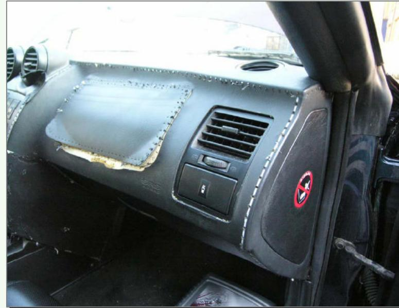
**Beispiel: Airbagausbau / -manipulation (Frontairbags)**
