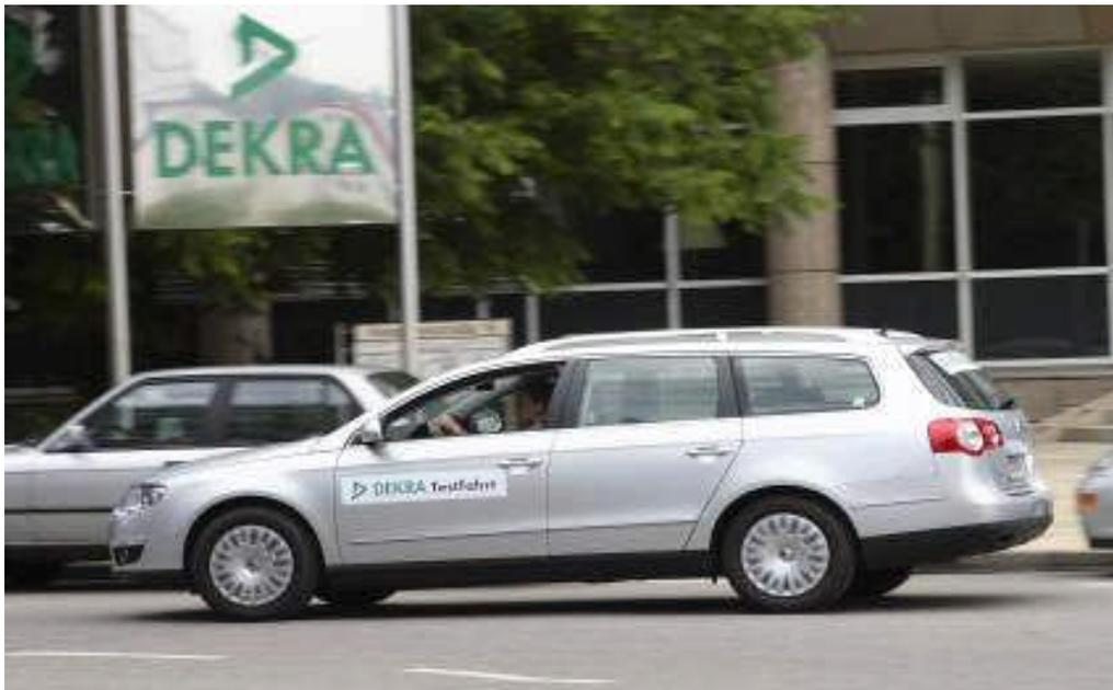
VW Passat Variant TDI, Bj. 2006, 1.9l Diesel, 77kW (105PS), mit DPF, CO<sub>2</sub> - Wert 158g/km
