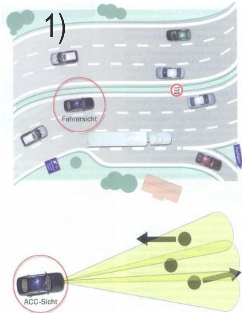
Bild 1: Fahrsicht (oben), ACC-Sicht (unten)
