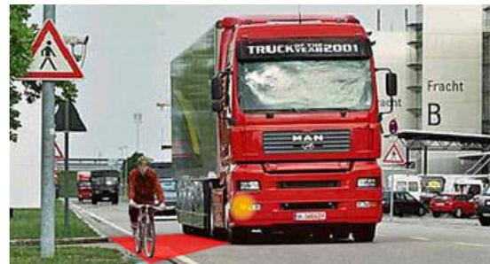
Abbiegeassistent und Blind-Spot-Detection
