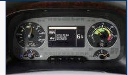
Radarsensorik des Abstandsregeltempomaten erkennt Entfernung zum vorausfahrenden Fahrzeug und führt in Gefahrensituation automatisch Notbremsung durch
