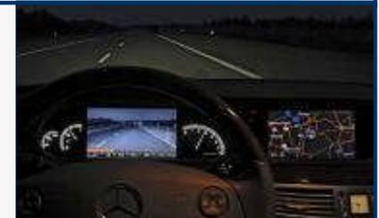
Sichtunterstützung während Dämmerungs- und Nachtfahrten mittels Infrarot
