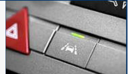
Infrarot-Linienerkennung erfasst die Fahrbahn, elektronische Datenauswertung und haptische Warnung bei unbeabsichtigter Fahrt auf Fahrbahnmarkierung
